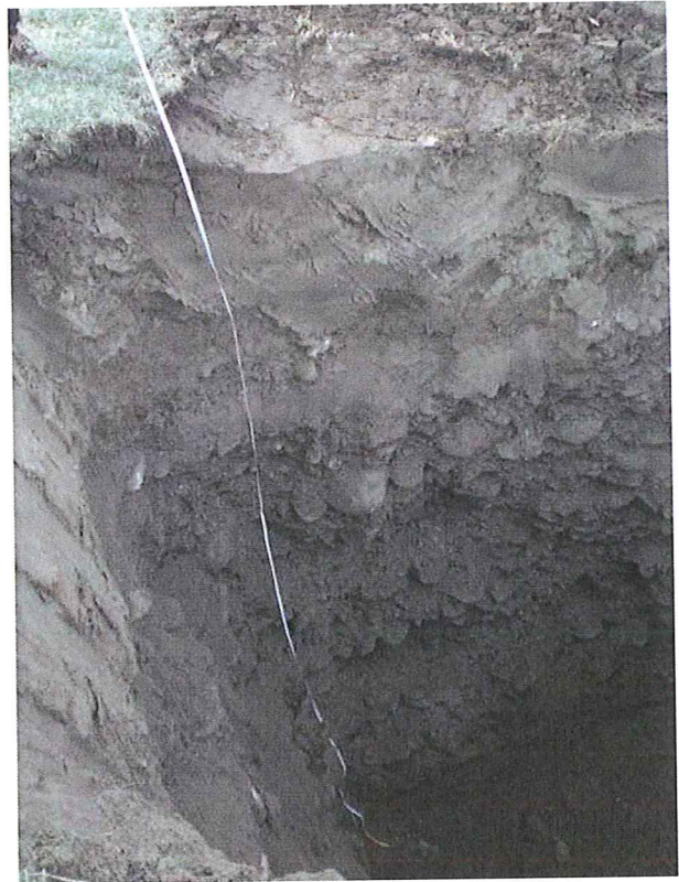
Foto 3: Baggerschurf mit sichtbarer Stratigraphie; 0- 0.5m Schluff + Feinsand 0.5- 5m Grobkörnige alluviale Ablagerungen aus gut gerundeten Geröllen + Kies in reichlich sandiger, schwach schluffiger Matrix
