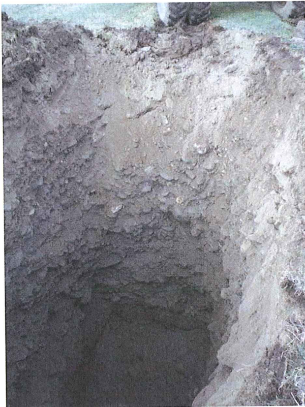
Foto 3: Baggerschurf mit sichtbarer Stratigraphie; 0- 0.5m Schluff + Feinsand 0.5- 5m Grobkörnige alluviale Ablagerungen aus gut gerundeten Geröllen + Kies in reichlich sandiger, schwach schluffiger Matrix
