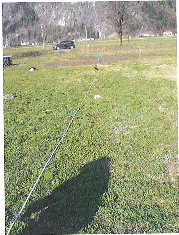
Foto 5: Seismische Untersuchungen; im Hintergrund das Wasserstandsmessrohr innerhalb des Baggerschurfes Foto 5: Stendimento sismico; allo sfondo il tubo piezometrico entro lo scavo geognostico
