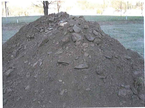
Foto 2: Aushubmaterial Baggerschurf Foto 2: Materiale dello scavo geognostico
