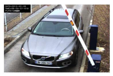
Zusätzlich zu den Fotos, die die Durchfahrt des Fahrzeugs dokumentieren, muss das System die Durchfahrtsdaten ausweisen, d.h.: Zeichenfolge des Nummernschilds des Fahrzeugs, Nationalität, Uhrzeit der Durchfahrt in Stunden/Minuten/Sekunden, Datum, Kennung der Videokamera sowie weitere, zusätzliche Daten, die der Kunde im Moment der Installation des Produkts anhand der Web-Schnittstelle konfigurieren kann.
