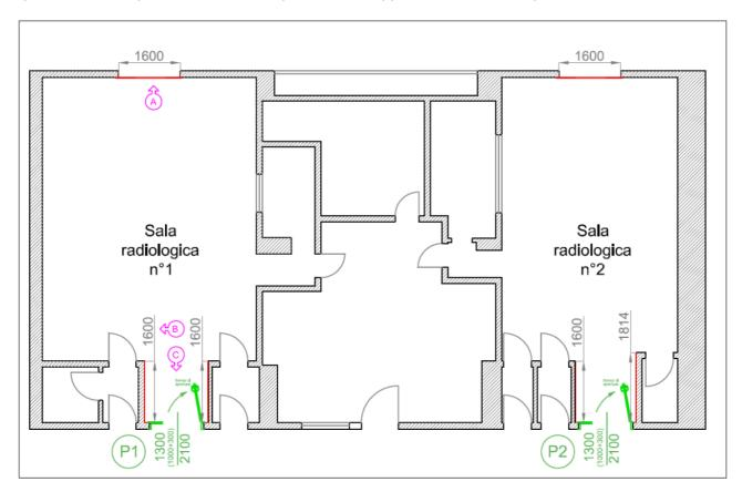
I tamponamenti sono stati costruiti in laterizio, all'interno dei quali è stata inserita una lastra di Pb da 2mm.
