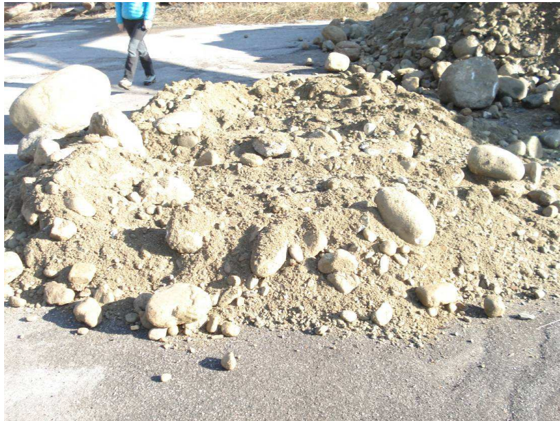
Material aus Baggerschurf 1: Zur Ermittlung der Großkörner.
